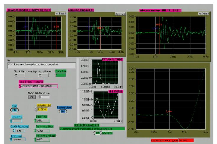
Les signaux acoustiques sont directement transférés sur un ordinateur et analysés sous Labview pour la détection des temps d'arrivées et l'analyse des signatures spectrales (spectre de puissance et phase).
