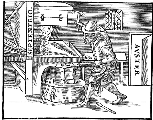
Fig. 2 Fabrication d'une aiguille de boussole par un forgeron. Gravure extraite de De Magnete [2, p. 139]. On note qu'il maintient une direction nord-sud ( septentrio-auster ) constante.
