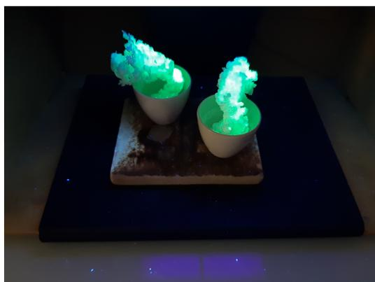
**Fig. 9** Composé phosphorescent obtenu suite à la synthèse utilisant 10 mg d'acide borique et placé à 600 °C.
