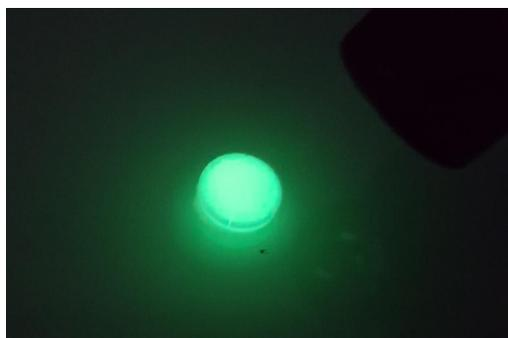
**Fig. 17** Pastille de silice dans laquelle les aluminates de strontium dopés ont été incorporés une fois la lampe éteinte.
