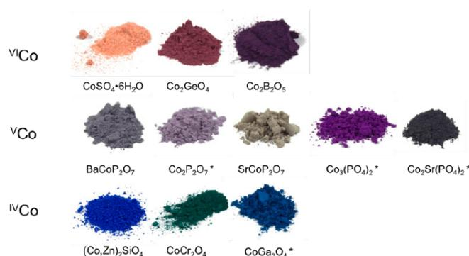
Fig. 2 Différents composés colorés dont la couleur est due à  $\text{Co}^{2+}$  à des coordinances différentes (indiquées à gauche en exposant de Co).<sup>1</sup>
