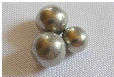
Fig. 12 Sphères de nickel purifié par le procédé Mond [30].
