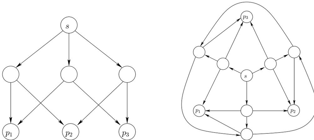
**Correction** Dans le réseau de gauche, sans network coding, on peut atteindre un débit de  $3/2$  au maximum (3 messages diffusés toutes les 2 unités de temps). Avec network coding, on peut atteindre un débit de 2, par exemple avec l'allocation suivante ( $\oplus = XOR$ ) :
