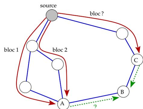
**Correction** Il suffit que le nœud A envoie le message  $B_A = B_1 \oplus B_2$  : quelque soit l’autre bloc  $B_B$  reçu du nœud B, on pourra reconstituer le bloc manquant en calculant  $B_A \oplus B_B$  ( $\oplus = \text{XOR}$ ). □
