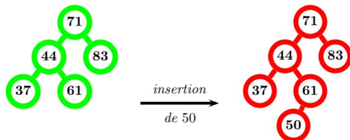
Effectuons une **double rotation droite** = une rotation gauche du sous-arbre gauche suivie d'une rotation droite
