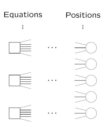
Le graphe possède deux types de sommets, les équations et les positions. Les équations sont d'arité 6 et les position d'arité 3.
