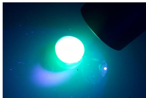
**Fig. 16** Pastille de silice dans laquelle les aluminates de strontium dopés ont été incorporés éclairée sous lampe UV.
