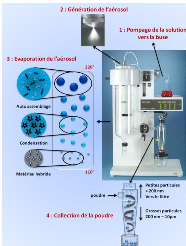
**Fig. 7** Principe de fonctionnement d'un atomiseur.<sup>10</sup>
