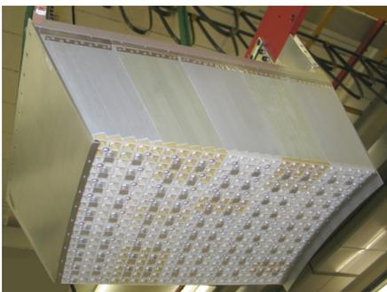
**Fig. 6** Photographie du module équipé de cristaux scintillants de  $\text{PbWO}_4$ .<sup>9</sup>
