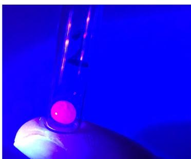
**Fig. 14** Bille fluorescente sous lampe UV (365 nm) obtenue après incorporation du composé phosphorescent dans du verre.
