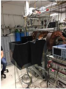
Certains prototypes expérimentaux ont des bobines (en LR1 047, machine à bobine de 20 gauss maximum)
