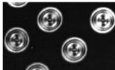
Torons dans un échantillon homéotrope photographiés entre polariseurs croisés.
