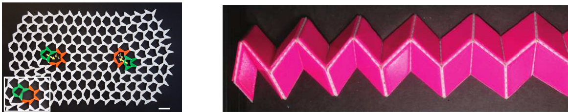
FIGURE 1 – Deux exemples de méta-matériaux topologiques. Gauche : Cette structure est strictement indéformable à l'exception des liens reliés à certains défauts. Extrait de [2]. Droite : Une origami simple dont le transport des vibrations mécaniques est exactement analogue au transport des électrons dans un isolant topologique unidimensionnel. Extrait de [3]
